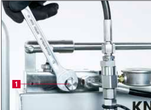
Bild 5-21 Hutmutter abschrauben
