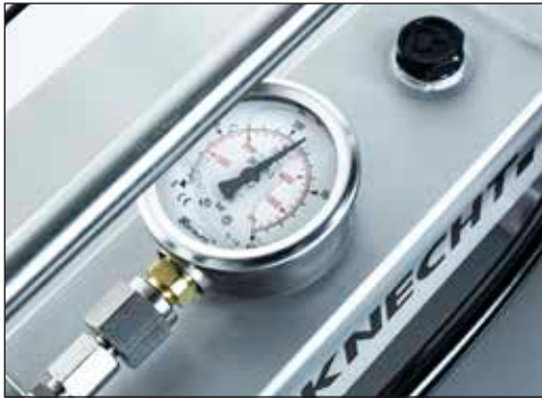
Bild 5-27 Korrekter Öffnungswert des Begrenzungsventils 220 bar
