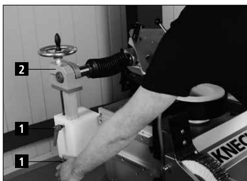
Bild 7-21 Kuttermesser auf Schleifscheibe einstellen
