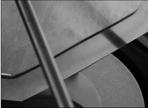
Bild 7-7 Richtig eingestelltes Messer
