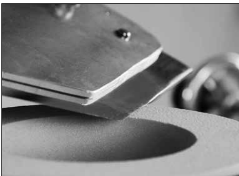
Bild 7-9 Richtig eingestelltes Messer
