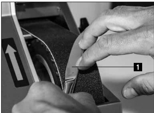
Figure 7-8 Pré-polir le couteau ménager
