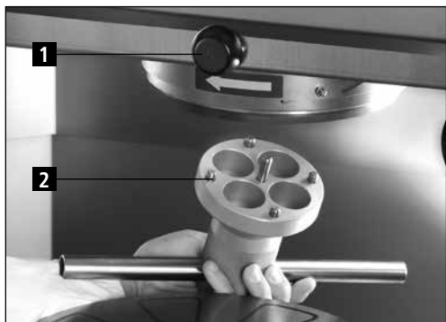
Figure 7-18 Remplacement du disque d'affûtage
