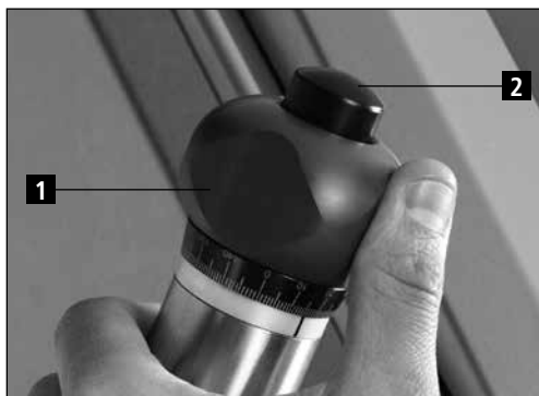
Figure 7-3 Réglage de précision «Table circulaire»
