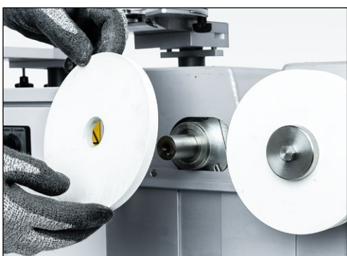
Bild 7-93 Schleifscheiben abnehmen und durch neue ersetzen
