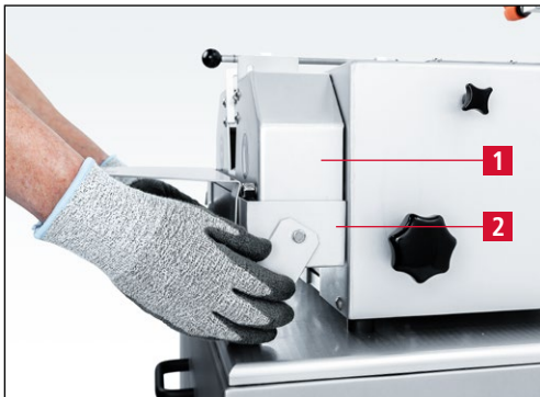
Bild 7-95 Schutzhaube und Wasserschale montieren
