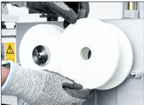
Bild 7-91 Schleifscheiben abnehmen und durch neue ersetzen
