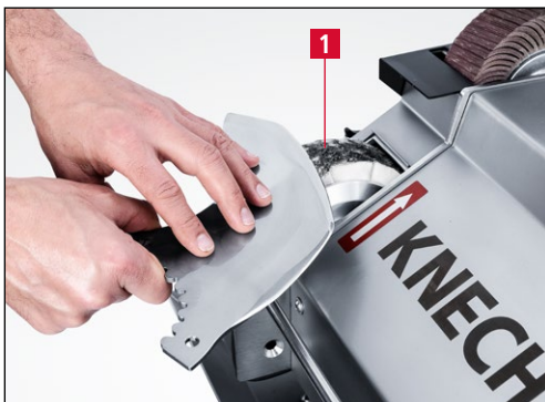
Bild 7-9 Kuttermesser entgraten und polieren
