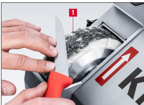
Bild 7-5 Handmesser entgraten und polieren
