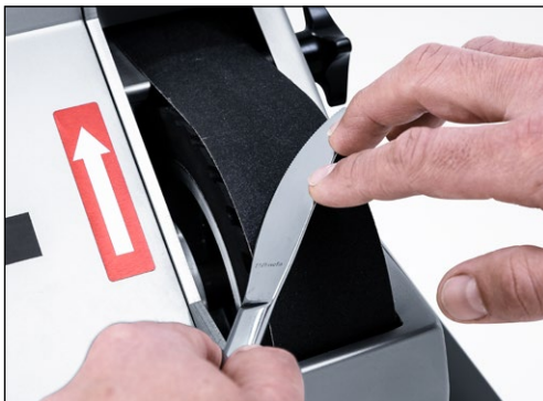
Bild 7-18 Bestehenden Wellenschliff heraus-schleifen
