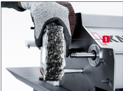
Bild 7-49 Polierscheibe abnehmen und durch neue ersetzen
