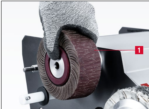
Bild 7-53 Lamellenschleifrad abnehmen und durch neues ersetzen
