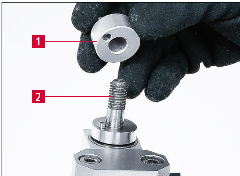
Bild 7-33 Distanzscheibe auf Aufnahmebohrungen stecken
