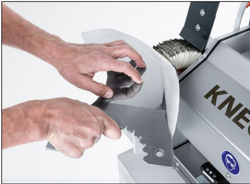
Bild 9-26 Kuttermesser auf der Lamellenbürste entgraten und polieren
