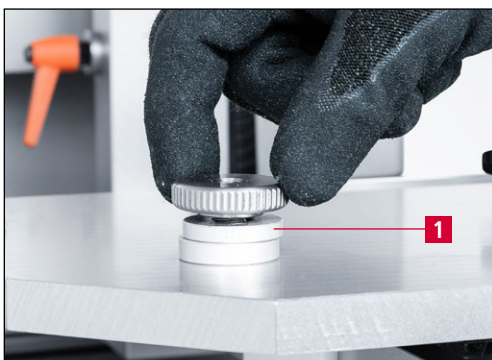
Bild 9-29 Distanzscheiben für die Schleifwinkel-einstellung
