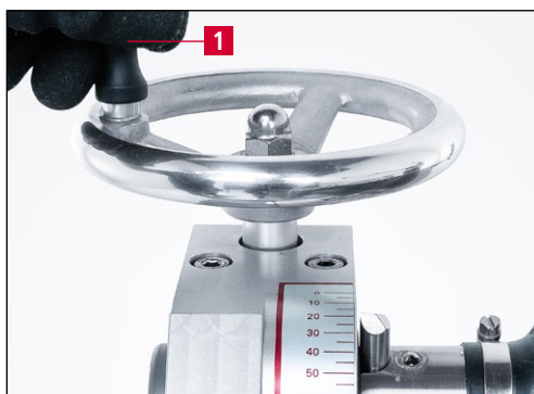
Bild 7-24 Schleifwinkel reduzieren (ballig schleifen)
