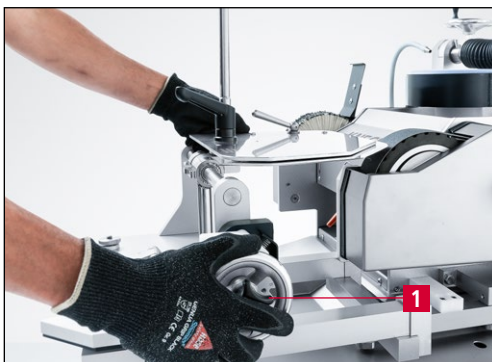
Bild 9-15 Schleifeinrichtung zum Schleifband bewegen
