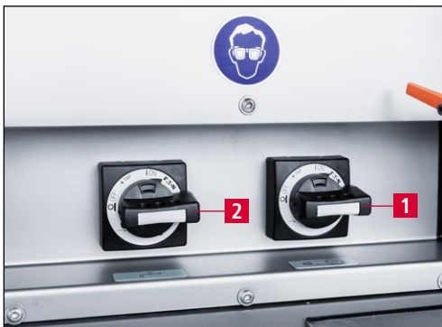
Bild 9-43 Schleifmaschine und Kühlmittleinrichtung einschalten
