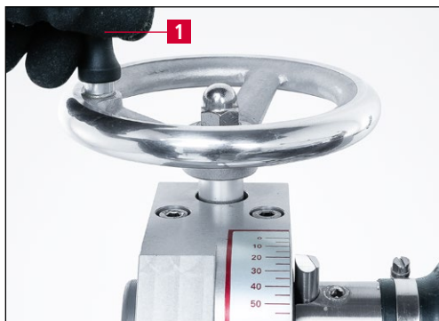
Bild 7-48 Schleifwinkel reduzieren (ballig schleifen)
