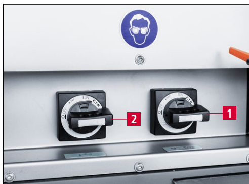
Bild 9-19 Schleifmaschine und Kühlmittleinrichtung einschalten
