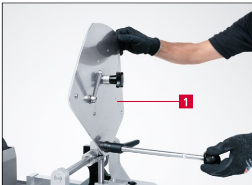
Bild 9-35 Schleifplatte nach hinten in die Verdrehsicherung schwenken
