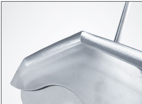
Bild 7-26 Ballig vorgeschliffenes Kuttermesser
