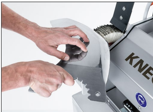
Bild 9-50 Kuttermesser auf der Lamellenbürste entgraten und polieren
