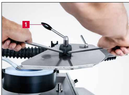
Bild 7-20 Lineare Messer mit Keilschliff schleifen
