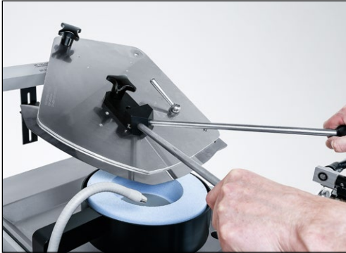
Bild 7-20 Kutmesser auf nächstes Schneidensegment schwenken und schleifen
