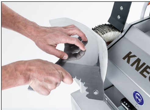
Bild 9-22 Kuttermesser auf der Lamellenbürste entgraten und polieren
