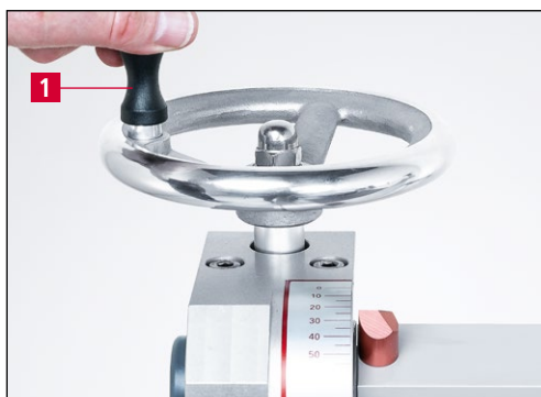
Bild 7-19 Schleifwinkel reduzieren (ballig schleifen)
