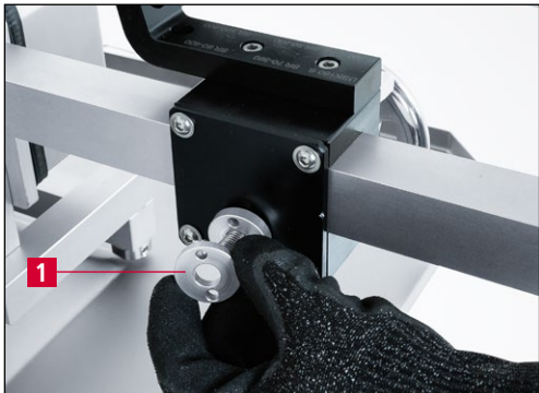
Bild 9-1 Distanzscheiben für die Schleifwinkel-einstellung
