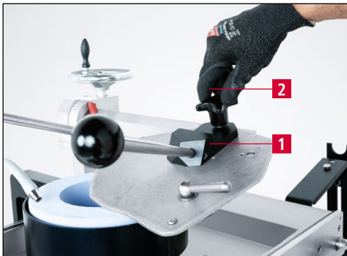
Bild 7-9 Schleifhebel auf Aufnahmebolzen montieren
