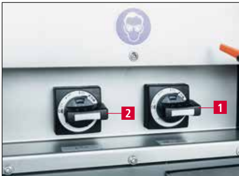
Bild 7-22 Schleifmaschine und Kühlmittleinrichtung einschalten
