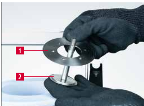
Bild 7-2 Kreismesser auf die passende Messeraufnahme legen
