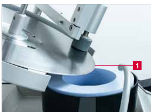
Bild 7-18 Kreismesser auf Schleifscheibe positionieren
