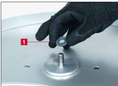
Bild 7-15 Zentrierscheibe auf Aufnahmebolzen stecken
