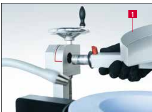
Bild 6-2 Kreismesserschleifeinrichtung HV 205-1 | HV 205-2 montieren
