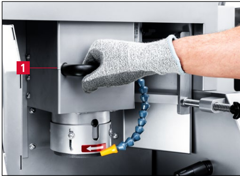
Bild 7-9 Schleifaggregat in Arbeitsposition bringen
