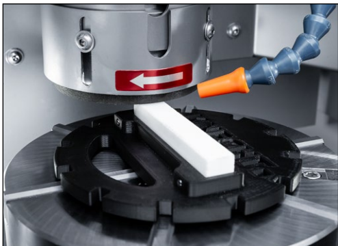
Bild 7-40 Schleifaggregat in Arbeitsposition
