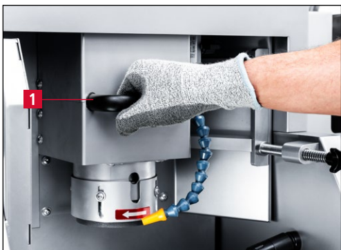
Bild 7-42 Schleifaggregat in Arbeitsposition bringen
