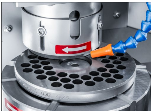
Bild 7-7 Schleifaggregat in Arbeitsposition
