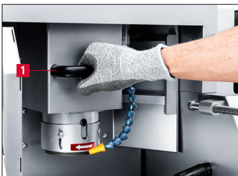
Bild 7-2 Schleifaggregat nach hinten schieben
