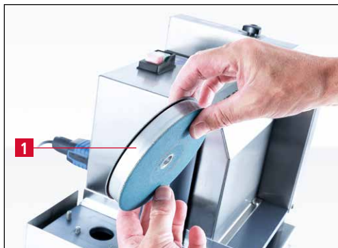
Bild 7-9 Neues Schleifscheibenpaar montieren
