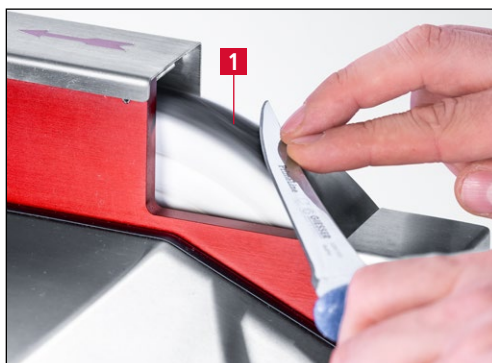
Bild 7-5 Handmesser entgraten und polieren
