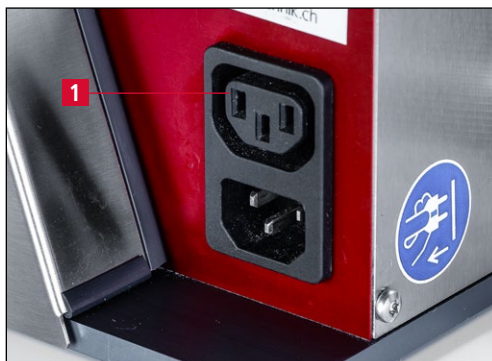
Bild 7-16 Anschluss für Industriestaubsauger
