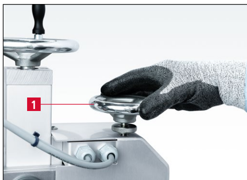
Bild 7-30 Handrad „Feinzustellung“ gegen den Uhrzeigersinn drehen
