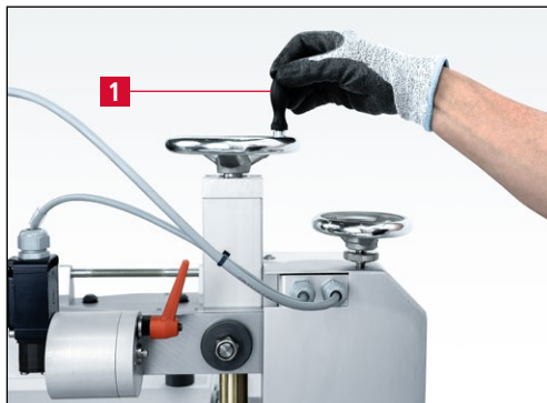
Bild 7-66 Kreismesser an die Schleifscheiben fahren
