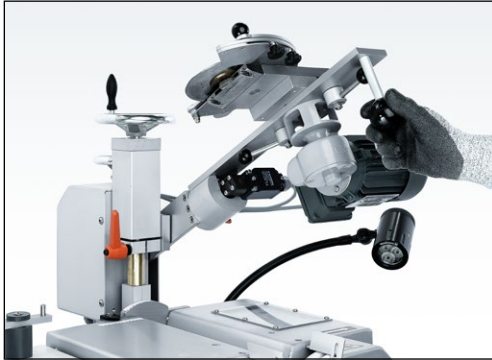
Bild 7-77 Kreismesserschleifeinrichtung in die Aufspannposition bringen
