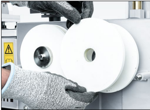
Bild 7-96 Schleifscheiben abnehmen und durch neue ersetzen
