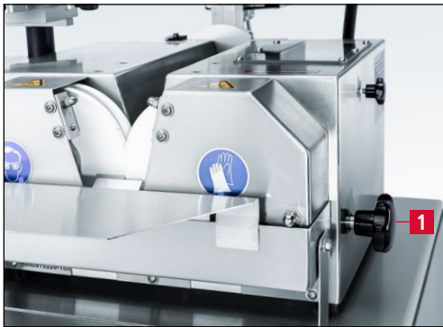
Bild 7-94 Wechselposition der Schleifscheiben
