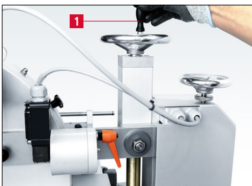
Bild 7-25 Kreismesser an die Schleifscheiben fahren
