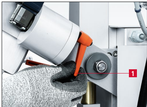
Bild 7-20 Klemmhebel „Aufnahmearm“ lösen
