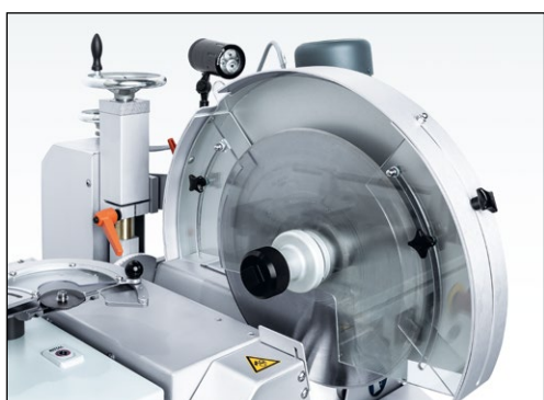
Bild 7-22 Kreismesserschleifeinrichtung in Schleifposition bringen
