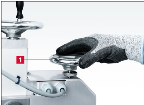
Bild 7-71 Handrad „Feinzustellung“ gegen den Uhrzeigersinn drehen
