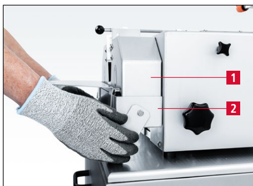
Bild 7-100 Schutzhaube und Wasserschale montieren
