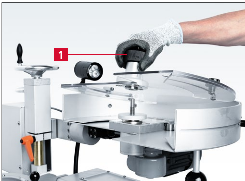
Bild 7-12 Spannmutter mit Schutzscheibe abnehmen
