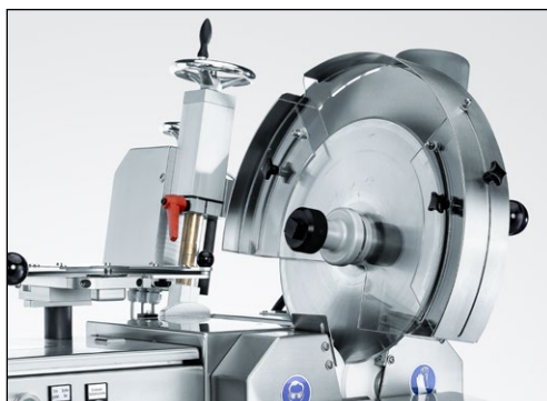
Bild 7-41 Schleifeinrichtung schräg stellen
