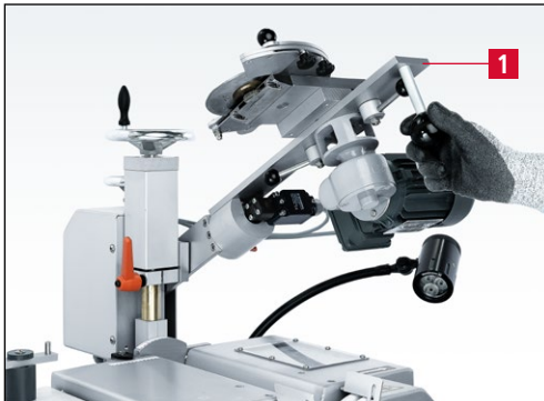
Bild 7-60 Kreismesserschleifeinrichtung nach oben drücken
