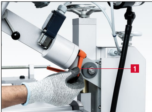
Bild 7-52 Klemmhebel „Aufnahmearm“ lösen
