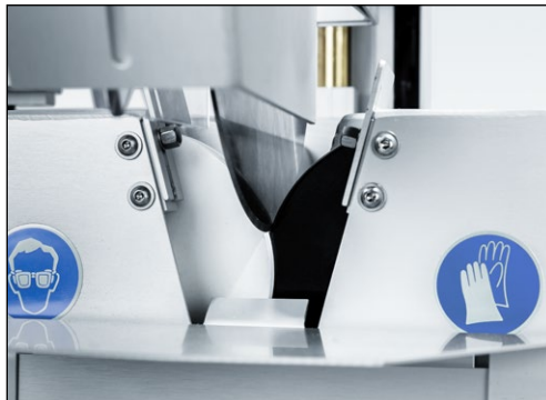
Bild 7-40 Verwendung einer gehärteten Stahlscheibe
