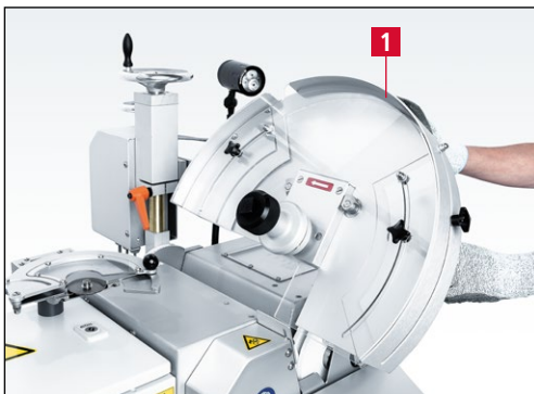
Bild 7-10 Kreismesserschleifeinrichtung im Uhrzeigersinn schwenken
