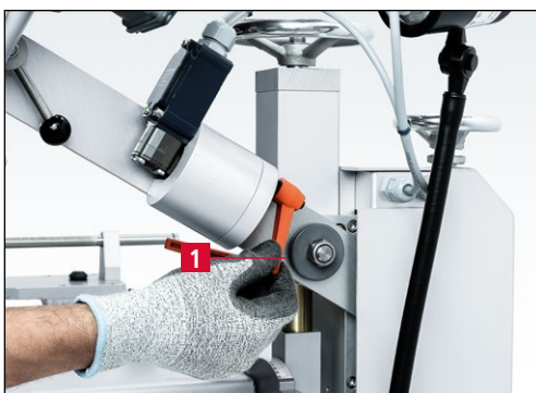
Bild 7-76 Klemmhebel „Aufnahmearm“ lösen
