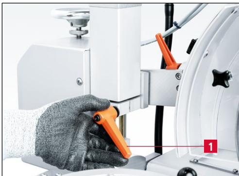
Bild 7-24 Klemmhebel „Höhenverstellung“ lösen
