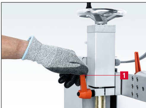
Bild 7-65 Klemmhebel „Höhenverstellung“ lösen
