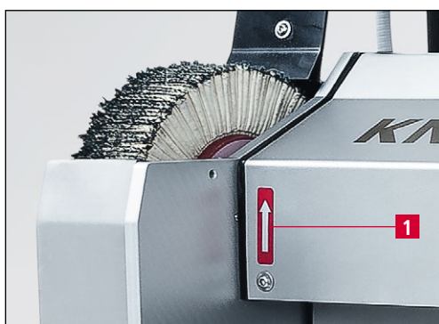
Figure 6-2 Contrôler le sens de rotation céder à l'inversion de phase.
