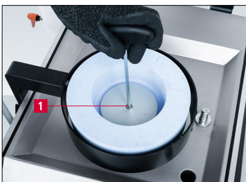
Figure 7-12 Remplacer le disque d'affûtage
