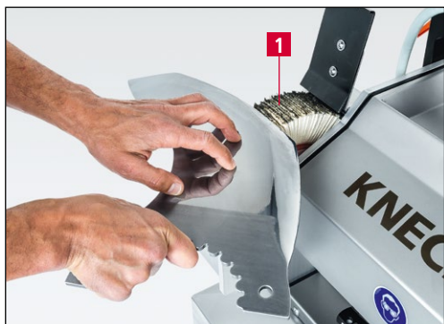
Figure 7-6 Démorfiler et polir le couteau de cutter
