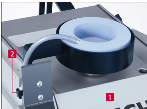
Figure 7-11 Régler la protection du disque d'affûtage
