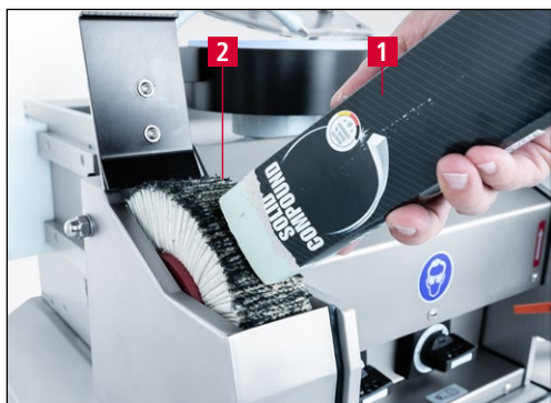
Figure 7-5 Appliquer la pâte de polissage
