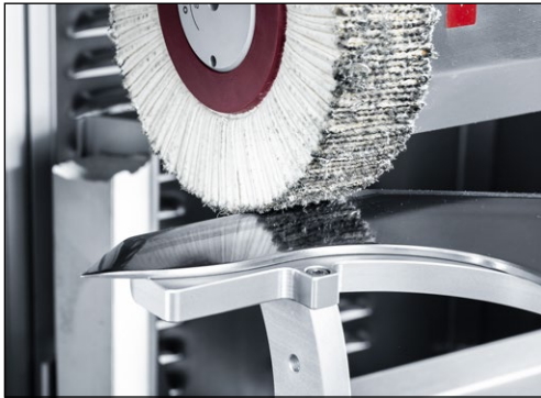
Bild 7-47 Polierbürste liegt auf dem Messer auf
