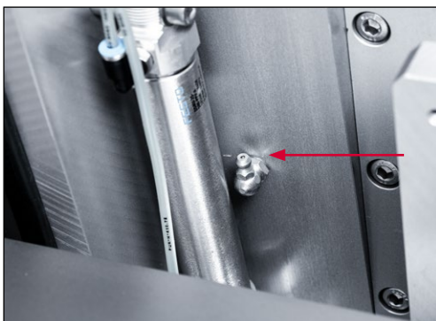
Bild 9-11 Führungsgehäuse hinten abschmieren
