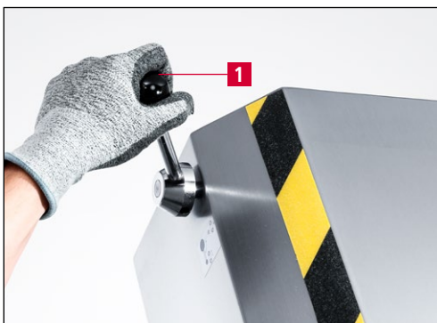
Bild 7-60 Bandentlastungshebel nach oben schwenken
