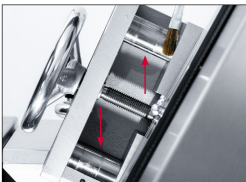
Bild 9-12 Führungen und Verstellspindel Winkeleinstellung abschmieren
