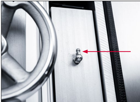
Bild 9-10 Führungsgehäuse vorne abschmieren
