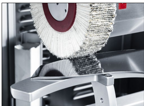
Bild 7-21 Polierbürste liegt auf dem Messer auf
