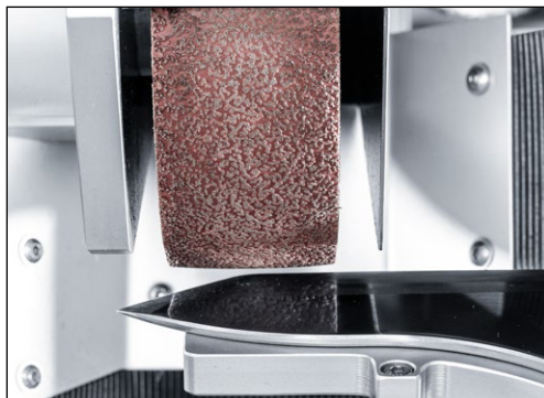
Bild 7-39 Weg der Kopierschleifplatte einstellen
