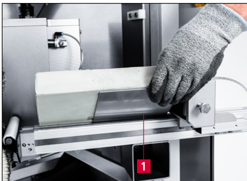
Bild 7-81 Polierpaste Entgrateinheit wechseln
