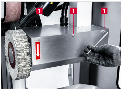
Bild 9-16 Abdeckung Poliereinheit abnehmen
