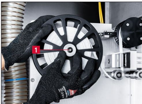
Bild 7-62 Gebrauchtes Testmedium entnehmen
