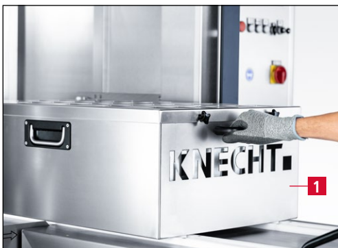
Bild 9-14 Leeres Messermagazin in die Maschine schieben
