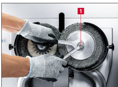
Bild 7-28 Rechte Spannmutter abschrauben
