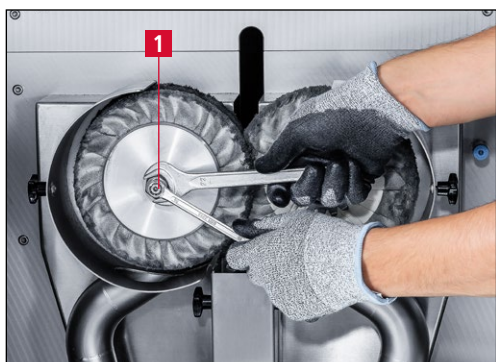
Bild 7-45 Linke Spannmutter abschrauben
