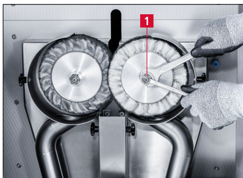
Bild 7-41 Rechte Spannmutter abschrauben
