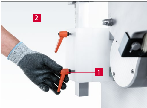
Bild 7-8 Kreismesser auf der Schleifscheibe positionieren
