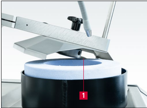
Bild 7-7 Kreismesser auf Schleifscheibe positionieren
