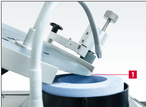
Bild 7-21 Kreismesser auf Schleifscheibe positionieren
