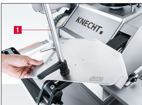
Bild 7-135 Kuttermesser auf nächstes Schneidensegment schwenken und schleifen
