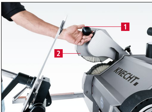
Bild 7-131 Obere Poliereinheit in Arbeitsposition bringen
