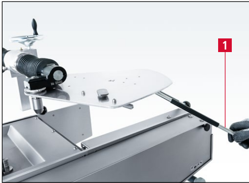
Bild 7-16 Schleifplatte nach hinten schwenken
