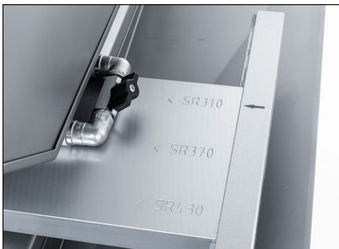
Bild 7-94 Eingestellte Position der Schleif- und Poliereinrichtung
