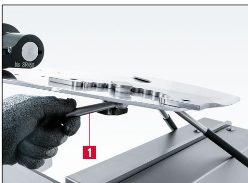
Bild 7-18 Messer auf Schleifplatte arretieren
