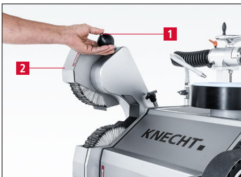
Bild 7-137 Obere Poliereinheit in Ruheposition
