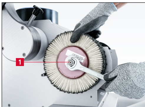
Bild 7-152 Untere Lamellenbürste wechseln
