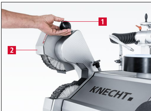
Bild 7-64 Obere Poliereinheit in Arbeitsposition bringen
