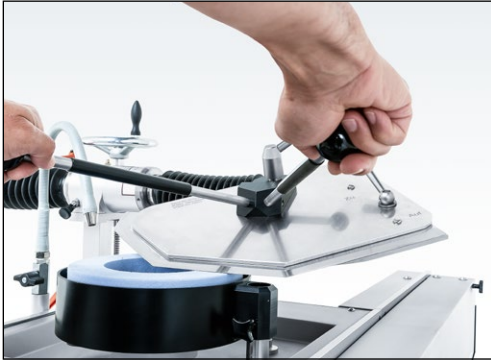
Bild 7-92 Kutmesser auf nächstes Schneidensegment schwenken und schleifen
