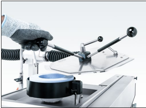
Bild 7-81 Schleifplatte nach vorne schwenken
