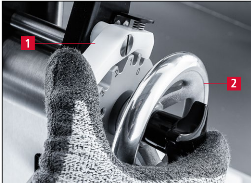
Bild 7-45 Schleifeinrichtung in die Einstellposition „0“ bringen
