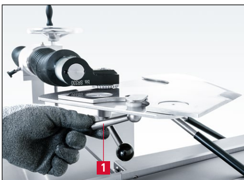
Bild 7-80 Messer auf Schleifplatte arretieren
