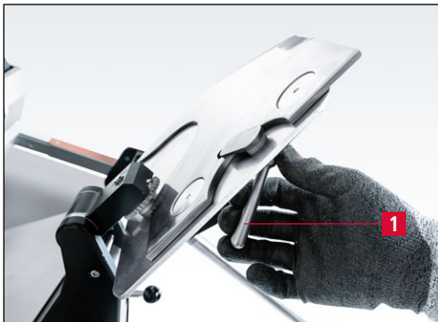
Bild 7-107 Messer auf Schleifplatte arretieren
