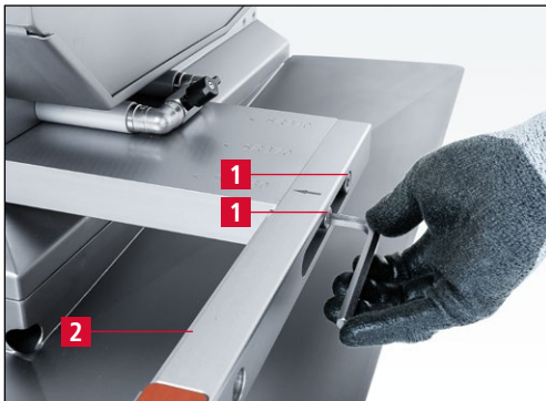
Bild 7-96 M 10 Schrauben lösen
