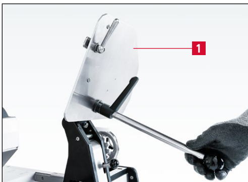
Bild 7-105 Schleifplatte nach hinten schwenken
