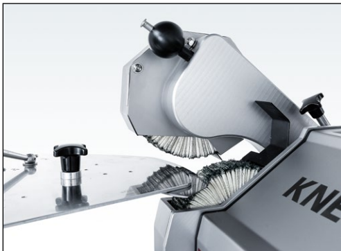
Bild 7-58 Distanz zwischen Lamellenbürsten ca. 20 mm
