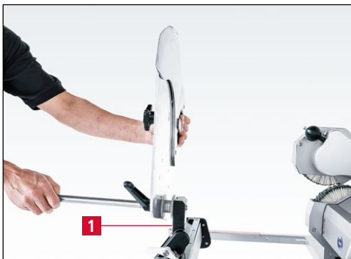
Bild 7-52 Kuttermesser zurückgeklappt und gesichert
