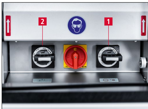
Bild 7-89 Schleifmotor und Kühlmittel-einrichtung einschalten
