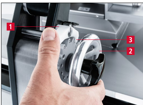
Bild 7-117 Schleifeinrichtung in Schleifposition „1“ bringen
