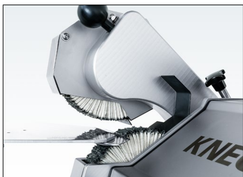
Bild 7-125 Distanz zwischen Lamellenbürsten ca. 20 mm
