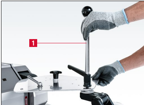
Bild 7-38 Schleifhebel leicht festziehen
