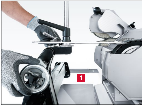
Bild 7-112 Schleifeinrichtung zum Schleifband bewegen
