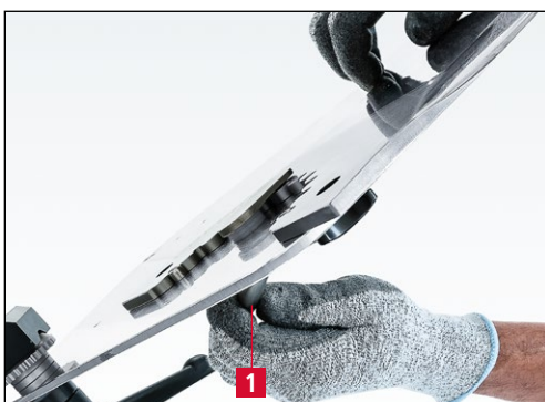
Bild 7-42 Messer auf Schleifplatte arretieren
