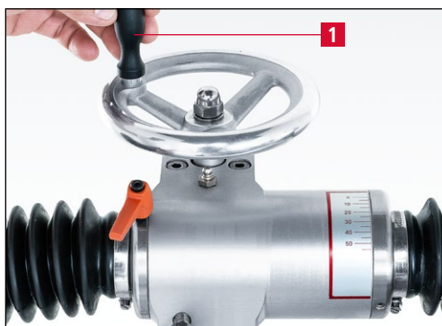
Bild 7-91 Schleifwinkel reduzieren (ballig schleifen)
